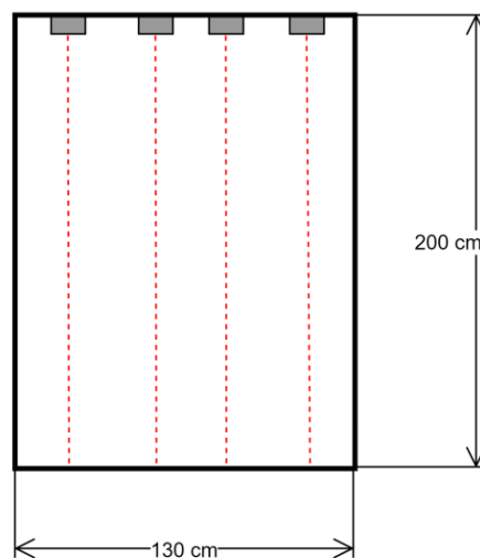
Figura 25. Distribución sensores para puerta (Fuente: elaboración propia)
