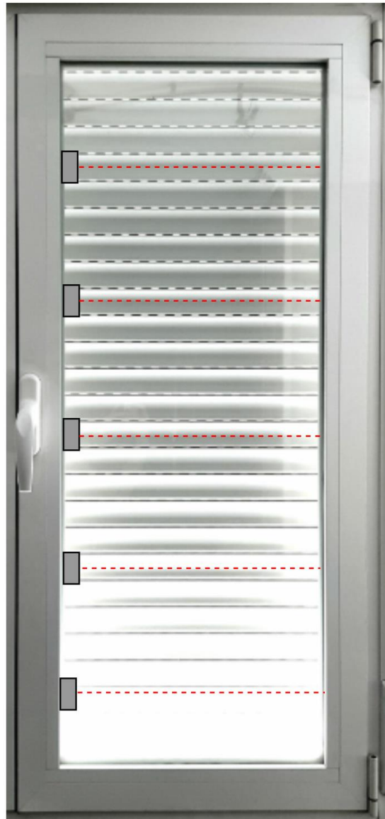
Figura 21. Ejemplo instalación de sensores de tiempo de vuelo en ventana real (Fuente: elaboración propia)
