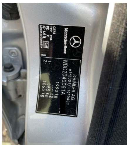
Figura 3. Ejemplo de placa de fabricante localizada en marca de puerta copiloto.
