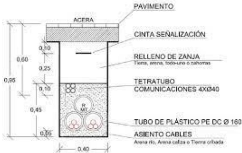
*Figura 39. Esquema de capas de las zanjas*
