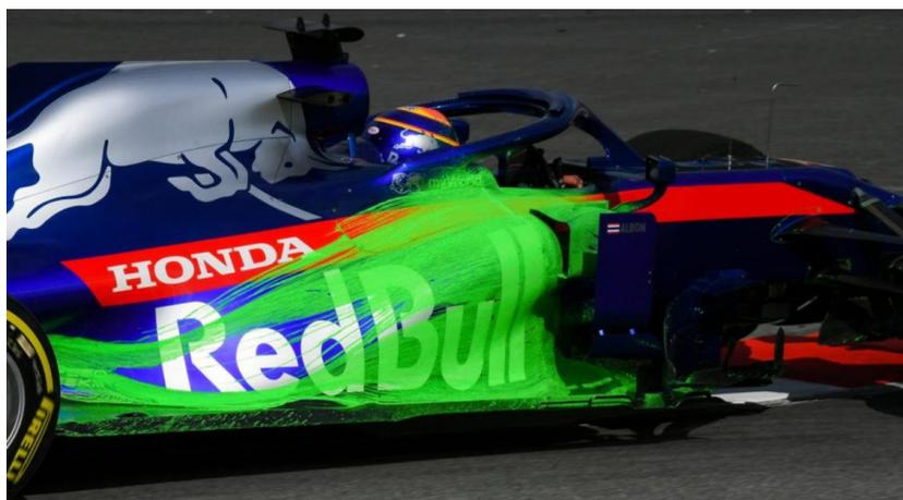
*Figure 11. Pruebas aerodinámicas realizadas en circuito [15].*
