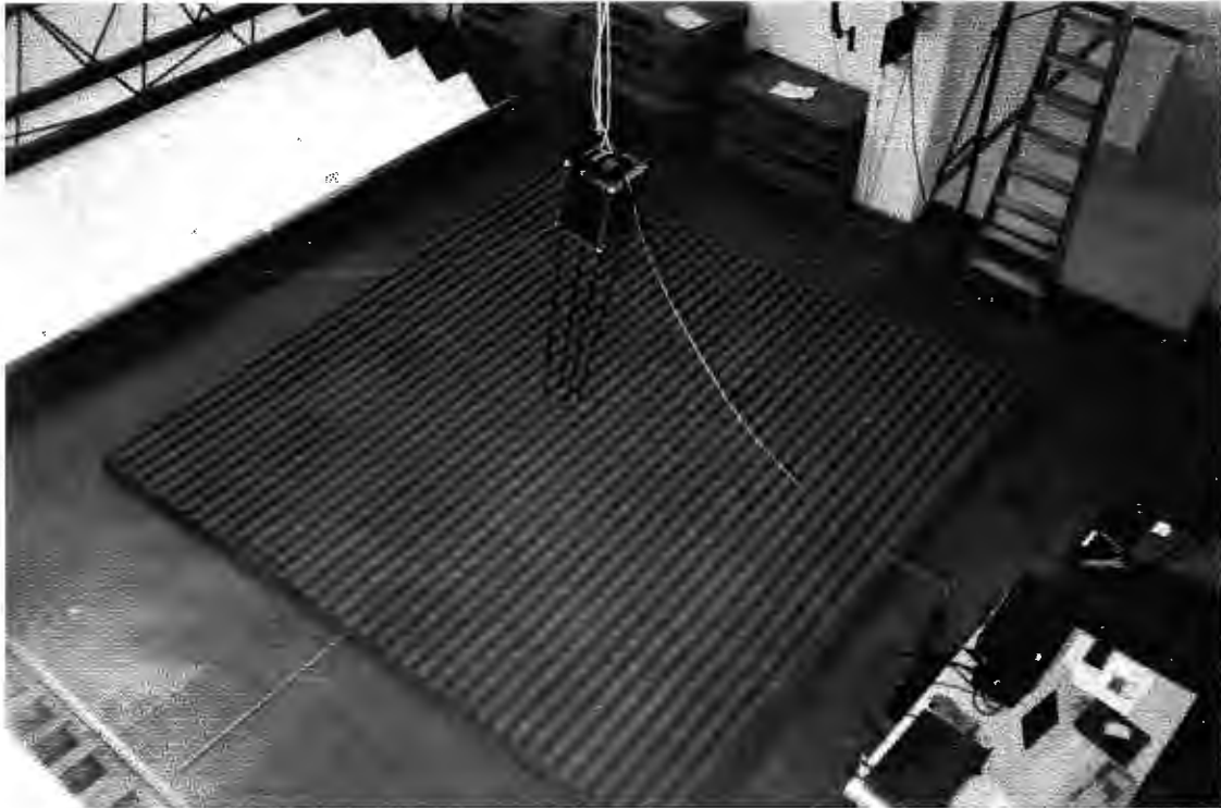
Figura 1.2.2.6. Realización de la medida de la pérdida por reflexión (RL) en laboratorio para una barrera de material Beton Bois.
