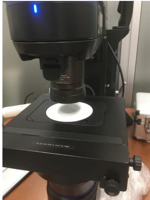
Figura 37: Microscopio utilizado en el análisis de estabilidad dimensional
