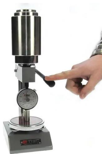
Figura 36: Durómetro para ensayo de Dureza Shore D
