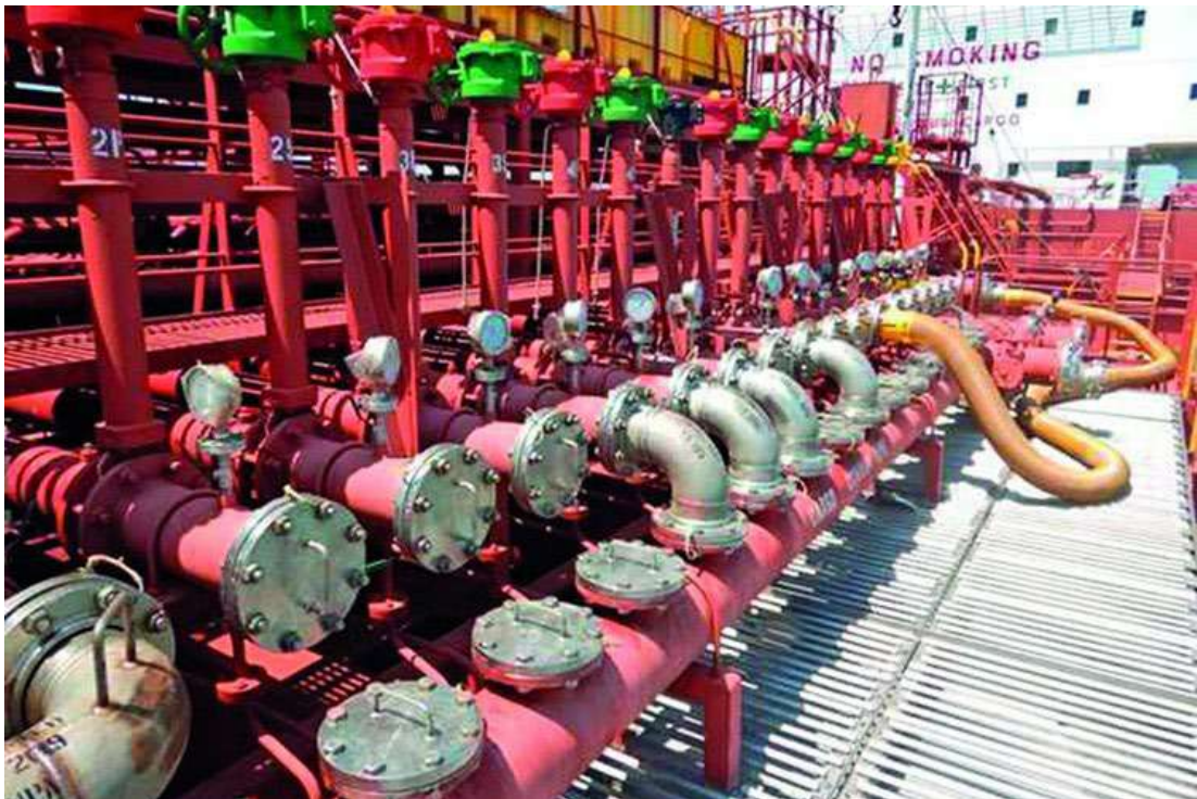
Figura 1.10. Manifold de un quimiquero. Fuente: IME
