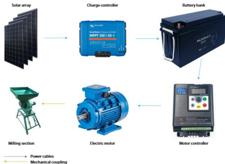
Ilustración 62. Esquema diseño molino solar con batería (Efficiency for Access, 2020)
