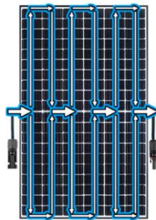
Ilustración 7. Tecnología Half Cell.
