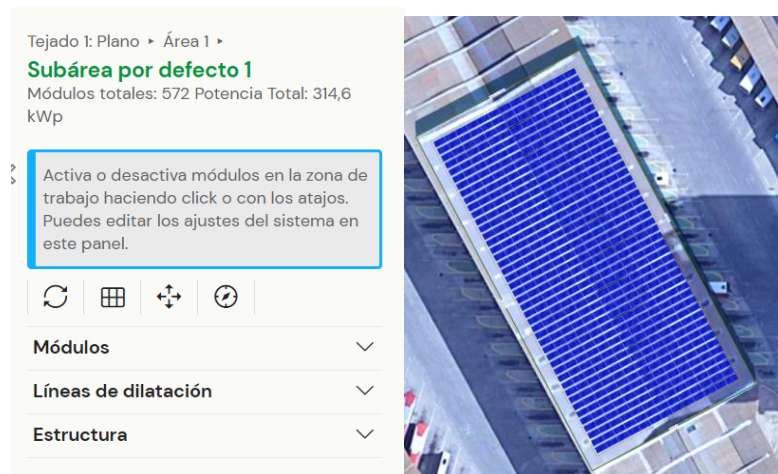
Ilustración 39. Parámetros módulo fotovoltaicos instalación.
