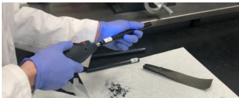
Ilustración 4: lijado de los tubos de fibra
